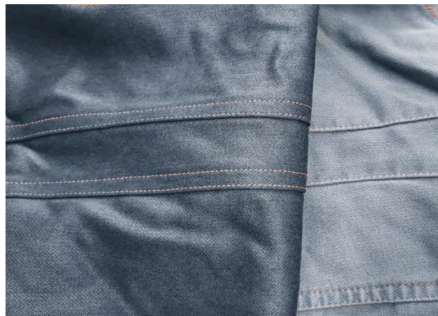
Doppel- statt Einfachnaht: Kleine Änderungen optimieren die Haltbarkeit.
